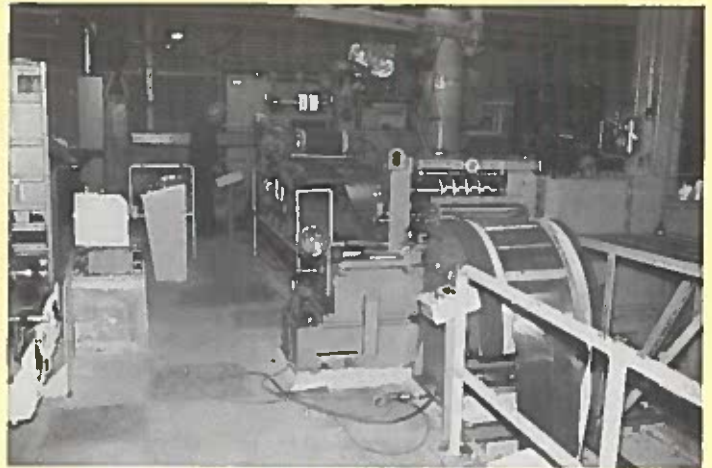
Vue d'ensemble de la ligne de cisailage. M. BALAINE surveille l'opération d'enroulage des bandes cisailées.
